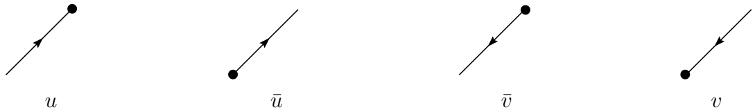
Figure 5: Regole di Feynman per stati iniziali e finali fermionici. La freccia fermionica segue il flusso della carica della particella (e non l'impulso!); ad esempio carica - per l'elettrone. La macchia nera indica il diagramma di Feynman.
