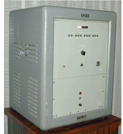
Il convertitore analogico-digitale a 11 bit DATRAC progettato da Bernard M. Gordon presso la Epsco. Era realizzato con tubi a vuoto e pesava circa 70 kg.
