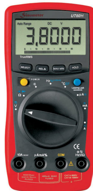
Multimetro digitale da 4 cifre e \frac{3}{4} . In questo caso possono essere mostrate 4 cifre ed inoltre sono disponibili 3 bit attraverso i quali codificare il segno ed i numeri tra 0 e 3. Pertanto la massima indicazione mostrata dallo strumento è \pm 3999 (UNI-TREND Technology).
