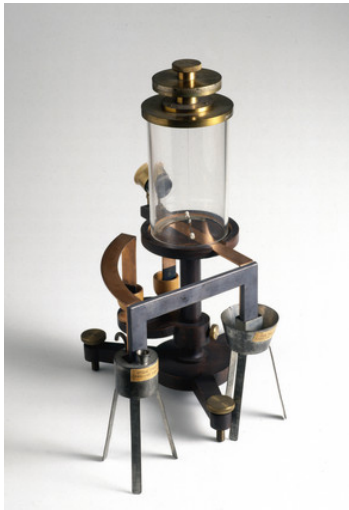
Riproduzione dell'apparato adoperato da Ohm. La corrente che attraversa una barra metallica deflette l'ago magnetizzato situato sopra di essa e contenuto all'interno di una campana di vetro; l'angolo di deflessione è proporzionale alla intensità della corrente. Il generatore di forza elettromotrice è una termocoppia le cui due estremità sono, rispettivamente, riscaldate col vapore e raffreddate col ghiaccio all'interno di appositi contenitori (Science Museum, Londra).
