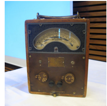
Una delle prime versioni dell' AVOmeter . La selezione del tipo di misura (corrente, tensione o resistenza) è fatta con la manopola di destra, la portata si cambia con la manopola di sinistra. I contatti per la misura sono in basso ( BBC ).
