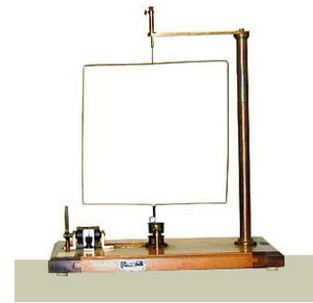
Banco di Ampère, dispositivo per lo studio dell'interazione di un campo magnetico con una spira percorsa da corrente.
