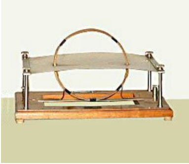
Dispositivo per lo studio del campo magnetico prodotto da una spira percorsa da corrente.
