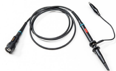
Sonda per oscilloscopio (Adafruit). In corrispondenza del connettore di collegamento all'oscilloscopio è visibile la vite per la regolazione del condensatore di compensazione.
