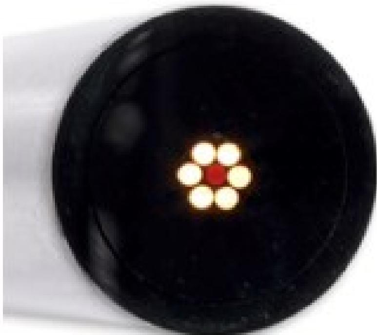
La sonda di riflessione consiste in un fascio di sette fibre ottiche aventi ciascuna un diametro di 400  $\mu\text{m}$ : sei di queste, posizionate in cerchio, forniscono l'illuminazione della superficie del campione, mentre la lettura in riflessione è affidata alla sola fibra in posizione centrale.
