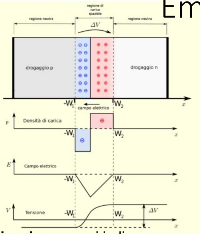
giunzione p-n si indica l'interfaccia che separa le parti di un semiconduttore sottoposte a drogaggio di tipo differente.
