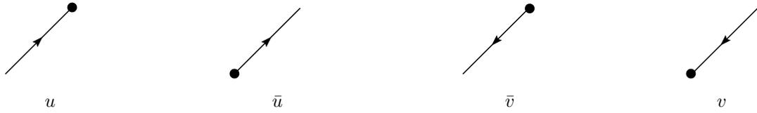
Figura 4: Regole di Feynman per stati iniziali e finali fermionici. La freccia fermionica segue il flusso della carica della particella (e non l'impulso!); ad esempio carica - per l'elettrone. La macchia nera indica il diagramma di Feynman.
