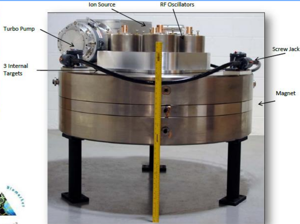
Mini-cyclotron (Ron Nutt, ABT)
