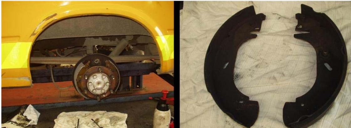
**Figura 18.1** Amianto nelle ganasce dei freni di un autocarro.
