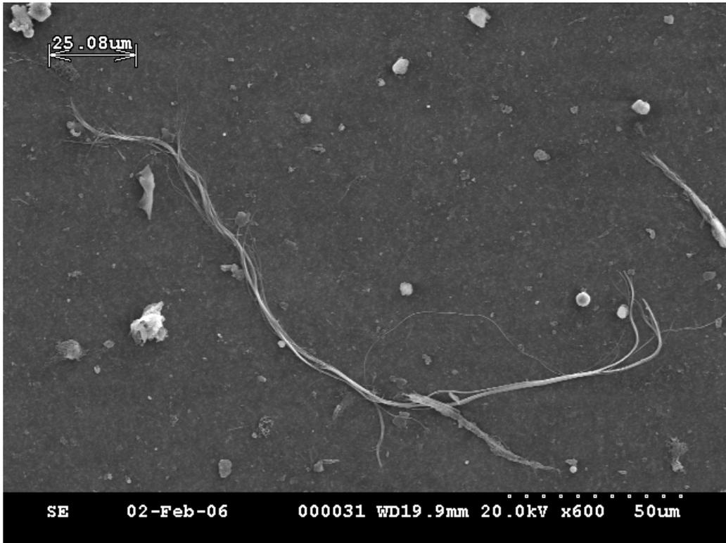
**Figura 2.2** Microfotografia al microscopio elettronico a scansione che mostra fibre di amianto crisotile
