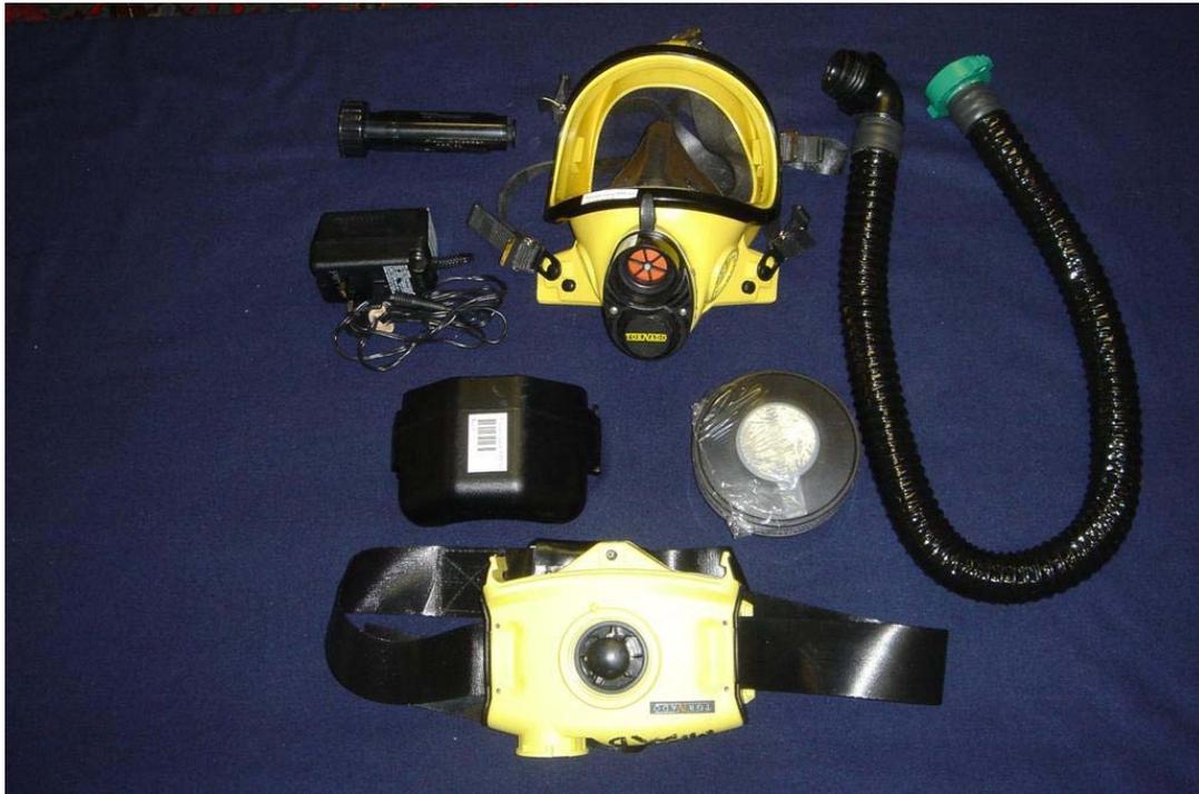
**Figura 8.2** Dispositivo di protezione respiratoria. Immagine fornita dallo HSE del Regno Unito.
