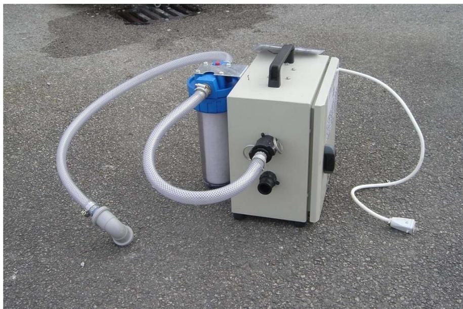
**Figura 8.1** Infiltrazione d'acqua per lo scarico dall'unità di decontaminazione. Immagine fornita dallo HSE del Regno Unito.
