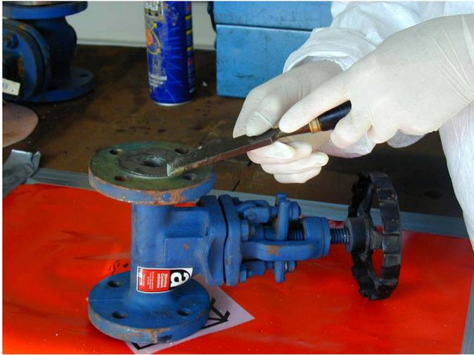
**Figura 11.5** Utilizzazione solo di strumenti a mano per pulire i giunti in amianto e i residui da una valvola.
