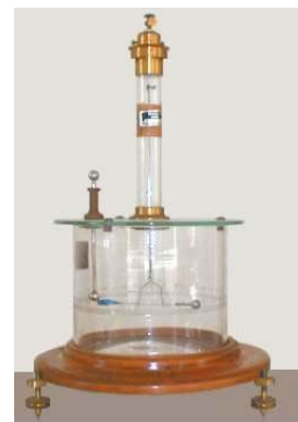
Bilancia a torsione per la verifica della legge di Coulomb
