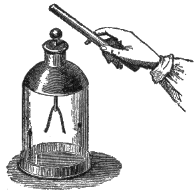
Elettroscopio a foglie d'oro. Si compone di due sottili lamine d'oro sospese da un'asta di ottone all'interno di un contenitore di vetro. Viene utilizzato per rilevare la presenza ed il segno di una carica elettrica. L'elettrizzazione dell'asta viene segnalata dalla divergenza delle lamine.
