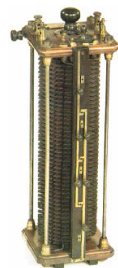
Trasformatore di Gaulard e Gibbs con nucleo rettilineo aperto
