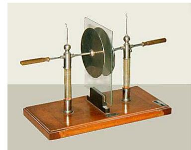
Apparato per lo studio delle caratteristiche del condensatore a facce piane e parallele.
