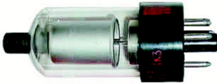
Diodo a vuoto per alta tensione (Silverton)
