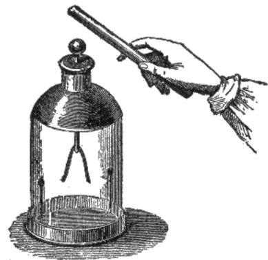
Elettroscopio a foglie d'oro. Si compone di due sottili lamine d'oro sospese da un'asta di ottone all'interno di un contenitore di vetro. Viene utilizzato per rilevare la presenza ed il segno di una carica elettrica. L'elettrizzazione dell'asta viene segnalata dalla divergenza delle lamine.
