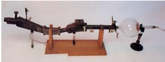
Spettrometro di massa realizzato da Aston nel 1925 (Cavendish Laboratory museum, Cambridge)
