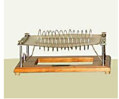
Dispositivo per lo studio del campo magnetico prodotto da un solenoide percorso da corrente.
