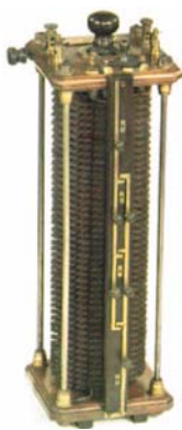
Trasformatore di Gaulard e Gibbs con nucleo rettilineo aperto
