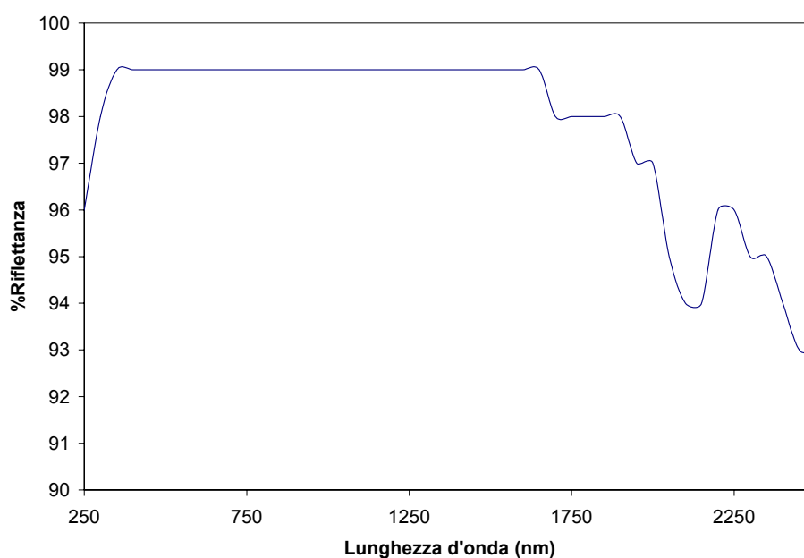
Figura 3.12. Risposta in riflettanza dello Spectralon® tra 250 e 2500 nm.
