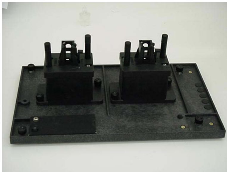
Figura 3.3. Porta campioni dello spettrofotometro, uno per il fascio principale, l'altro per il fascio di riferimento.
