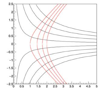
quadrante del piano cartesiano x-y, le curve di livello del potenziale sono illustrate in rosso in figura (per a = 2 e valori del potenziale pari a 2, 4, 6 e 8). In nero sono disegnate le linee di campo, ottenute con un algoritmo numerico iterativo (si veda il riquadro). La densita' di carica e' data
