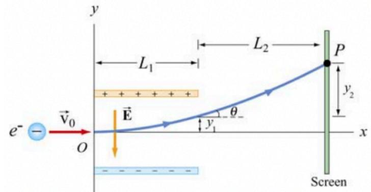
spostamento verticale totale  $y_1 + y_2$  tra il tempo  $t_0$  e il tempo  $t_2$  in cui l'elettrone raggiunge lo schermo dopo aver percorso una distanza complessiva in direzione  $x$  pari a  $L_1 + L_2$ .
