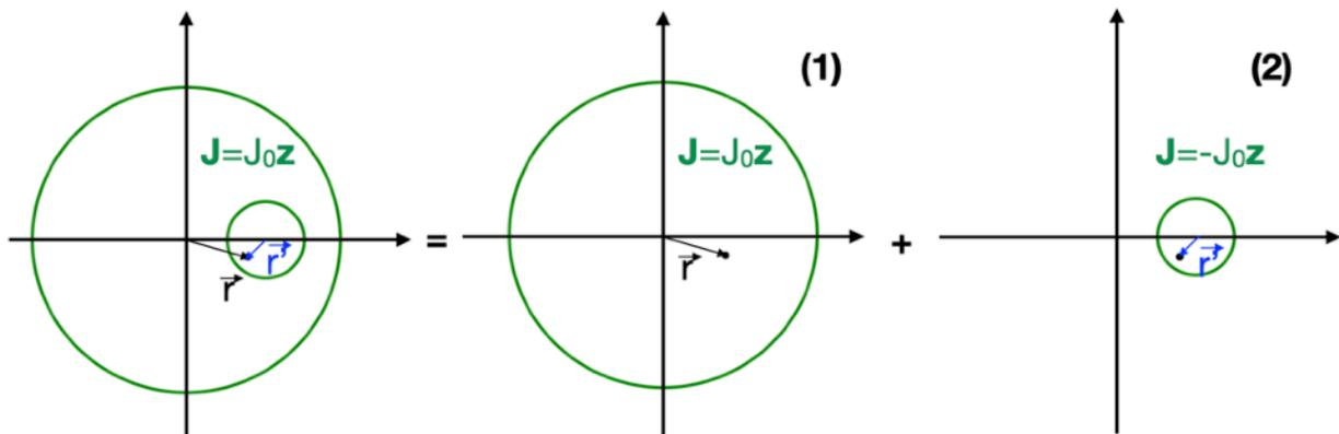
Il campo in ogni punto dello spazio e' la sovrapposizione dei campi prodotti dalla sorgente descritta in (1) e dalla sorgente in (2). Per calcolare il campo in entrambe le situazioni dobbiamo valutare il campo all'interno di una distribuzione di corrente. Applicando la legge di Ampere a un percorso circolare nel piano xy con raggio r = distanza del punto in cui calcolare il campo
