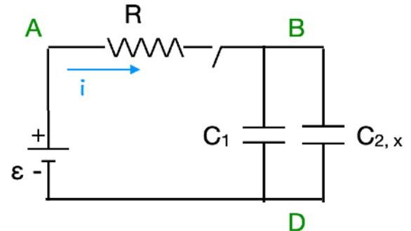
Il circuito descritto nel problema e' rappresentato in figura. All'istante di tempo  $t=0$  l'interruttore viene chiuso. L'eq del circuito e'  $\phi(A) - \phi(D) = \epsilon = (\phi(A) - \phi(B)) + (\phi(B) - \phi(D)) = Ri(t) + Q(t)/C_{eq}$  dove  $C_{eq} = C_1 + C_{2,x}$  (si intenda  $C_2$  o  $C_x$  a seconda delle due parti
