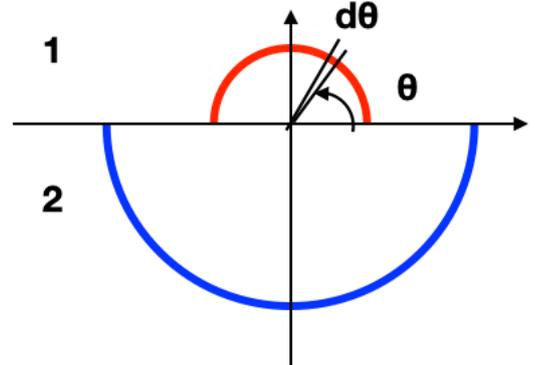
Il tratto di arco di lunghezza  $dl_1 = R_1 d\theta$  contribuisce al campo in (0,0) con  $d\vec{E}_1 = -k \frac{\lambda dl_1}{R_1^2} \hat{r} = -k \frac{\lambda d\theta}{R_1} \hat{r}$ .
