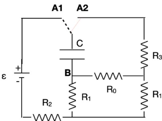
Al tempo  $t=0$  l'interruttore è chiuso su A1 (fig con bordo rosso) => comincia a scorrere la corrente  $i_g$  nel ramo del generatore, del condensatore e di  $R_2$ , la corrente  $i_0$  nelle due resistenze  $R_0$  ed  $R_1$  (rinominata  $R_{12}$  per distinguerla dall'altra) e la corrente  $i_1$  in  $R_{11}$ . Si ha quindi  $i_g = i_0 + i_1$  e l'eq del
