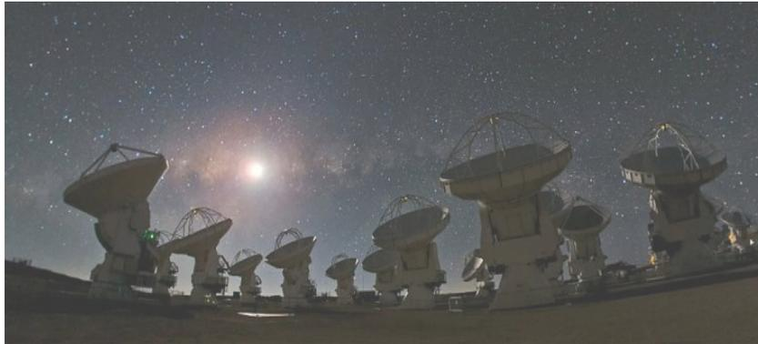
Figura 2.22: Vista notturna di una parte dell'interferometro ALMA (Atacama Large Millimeter Array) sulle Ande Cilene a circa 5000 m di altezza. ALMA è costituito da 64 antenne mobili con diametro di 12 m ed è pensato per ottenere immagini radio con risoluzioni spaziali anche minori di 1 arcsec, grazie ad al suo utilizzo come interferometro. (<http://www.hq.eso.org/projects/alma/>)
