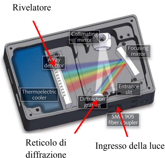
Figura 2: Struttura di un moderno spettrometro a reticolo.
