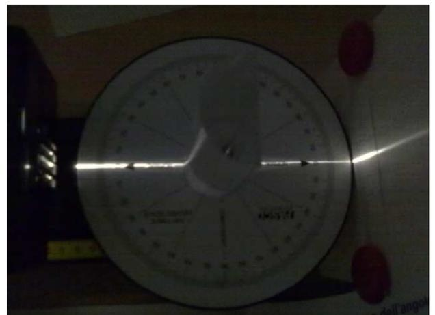
Fig. 3. Azzeramento del dispositivo di misura. In questa configurazione il raggio luminoso è perpendicolare ad entrambe le superfici di interfaccia aria-materiale plastico.
