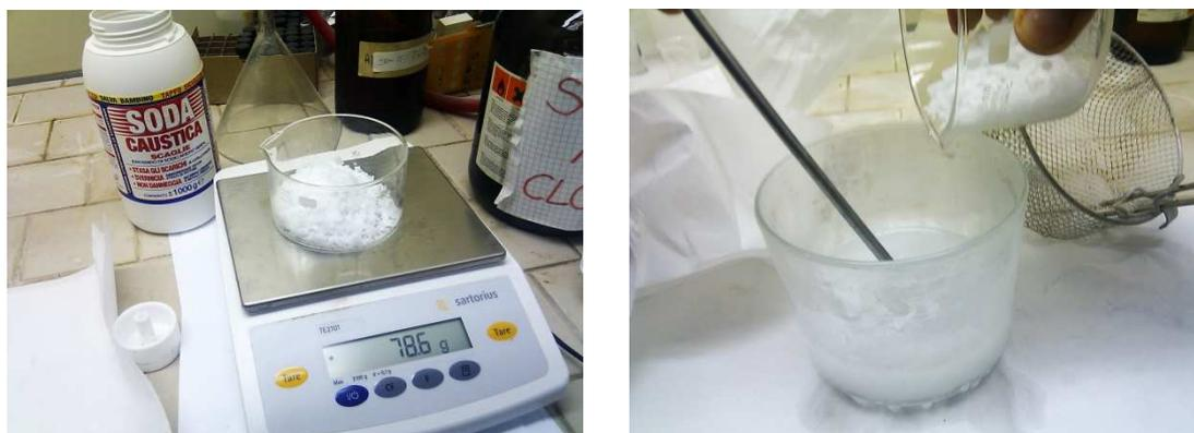
Fig. 3. Fasi di preparazione dell'attacco chimico del dosimetro.
