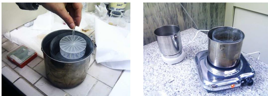
Fig. 4. Attacco chimico con bagno termostatico per dosimetri
