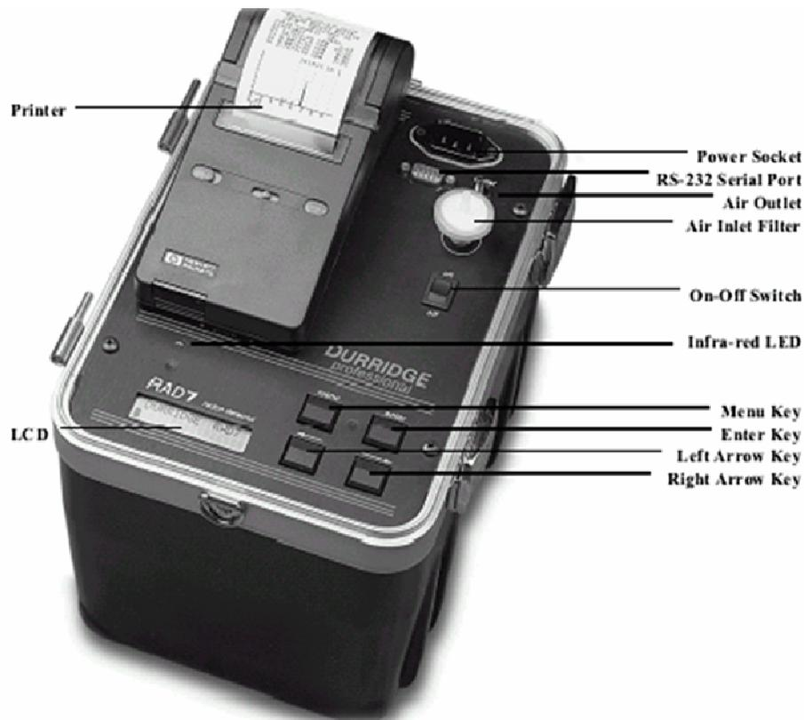
La misura della concentrazione di radon in aria è stata effettuata mediante il rivelatore elettronico prodotto dalla DURRIDGE Company modello RAD7.
