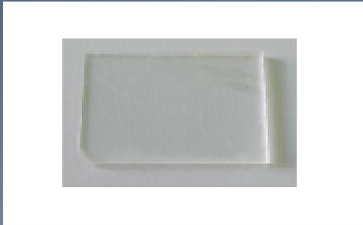
*Le lastre presentano delle tracce di fondo dovute ad imperfezioni legate al processo di produzione, con una densità differente per le due facce*
