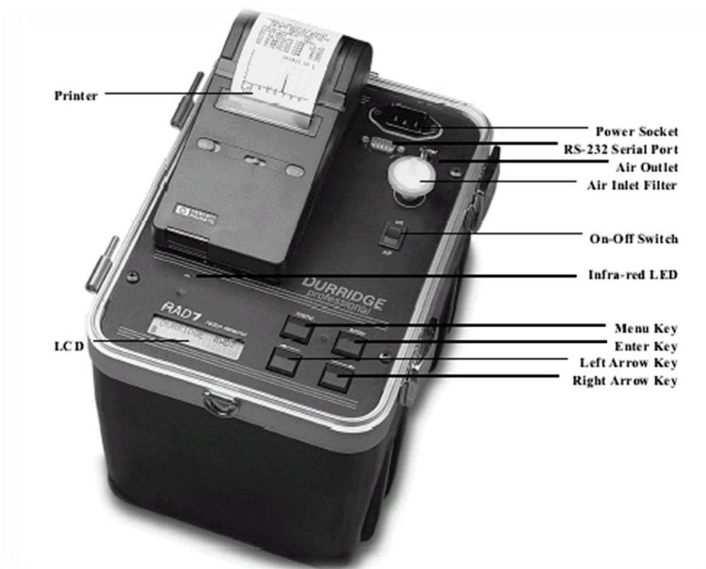
La misura della concentrazione di radon in aria è stata effettuata mediante il rivelatore elettronico prodotto dalla DURRIDGE Company modello RAD7.
