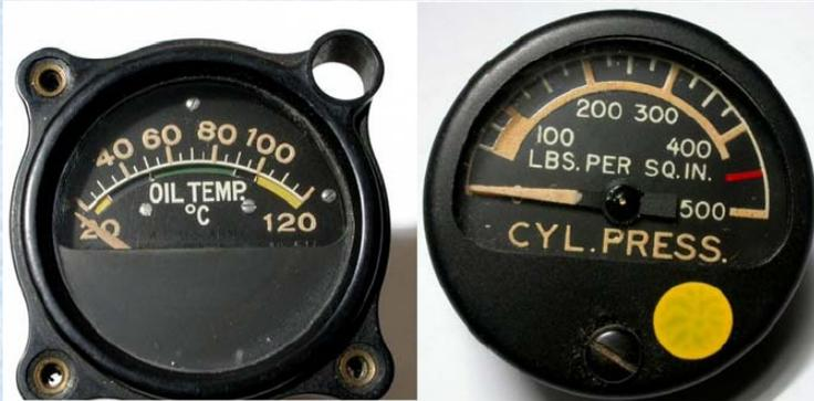
Strumentazione con vernici radioluminescenti
