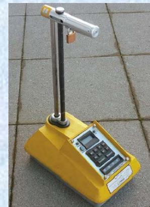
Sonda per misurazione dell'umidità e della densità di bitume e catrame
