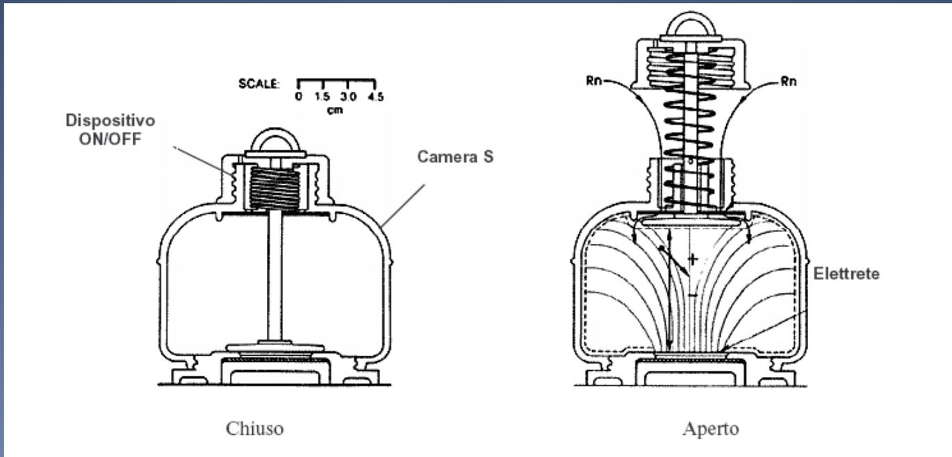
Il sistema E-Perm si posiziona ad un'altezza compresa tra uno e due metri e in modo tale che sia completamente circondato dall'aria, evitando di coprirlo e/o di collocarlo a ridosso del materiale da costruzione (muri, pavimenti, ecc.).
