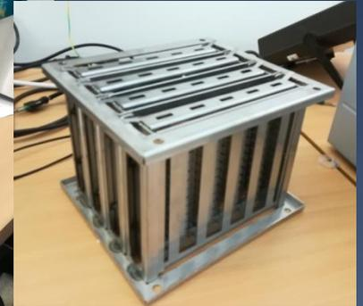
I rivelatori sono montati nel rack e inseriti nella vasca per l'attacco chimico in una soluzione di idrossido di sodio (NaOH) in acqua distillata (6.25 M) (250 grammi di NaOH solida per ogni litro di acqua) alla temperatura di 98°C per un'ora.
