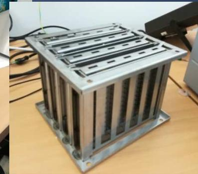
I rivelatori sono montati nel rack e inseriti nella vasca per l'attacco chimico in una soluzione di idrossido di sodio (NaOH) in acqua distillata (6.25 M) (250 grammi di NaOH solida per ogni litro di acqua) alla temperatura di 98°C.
