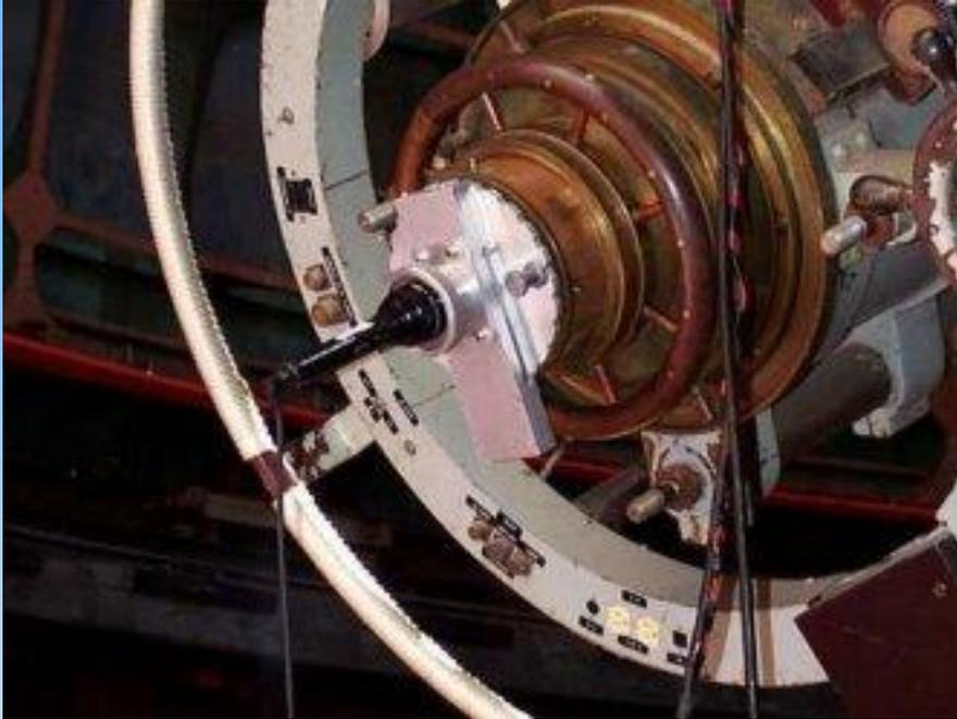
Gli spettrografi e gli spettrofotometri vengono applicati all'estremità del telescopio dove l'obiettivo o lo specchio concentrano la luce (esattamente nel piano focale di questi ultimi)
