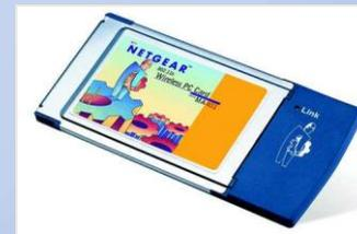
•Le schede PC card da inserire negli appositi slot di espansione dei portatili (PCM-CIA) oppure schede Wireless PCI
