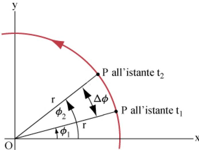
Consideriamo un punto materiale  $P$  che si muova per un tratto  $\vec{s}$  su un arco di circonferenza il cui raggio è  $r$ . Definiamo una quantità vettoriale,  $\vec{\phi} = \vec{s}/r$  (unità di misura radianti), il cui modulo è chiamato angolo di rotazione. Velocità angolare media
