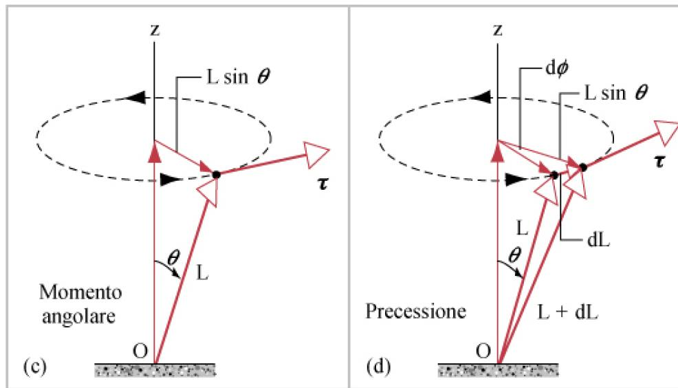
In generale  $d\phi/dt \ll \omega$  ma non nullo. Questo produce un moto di **precessione** attorno all'asse Z. Meglio identificata nel caso della trottola.
