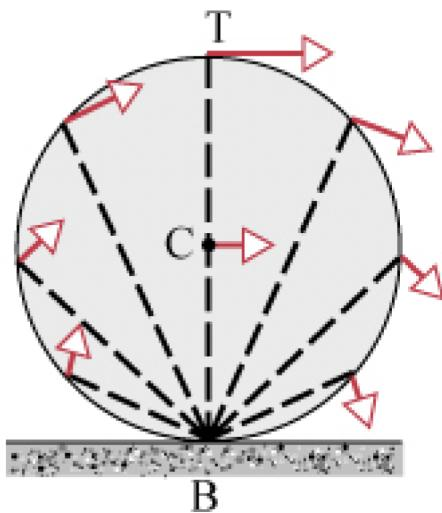
Il corpo in puro rotolamento ruota istante per istante intorno ad un asse passante per  $B$  (punto istantaneo di contatto) e perpendicolare al diametro  $BT$ . Tale asse è chiamato asse istantaneo di rotazione. La velocità angolare della rotazione del CM intorno a  $B$  è uguale alla velocità  $\omega$  della rotazione intorno al centro di massa.
