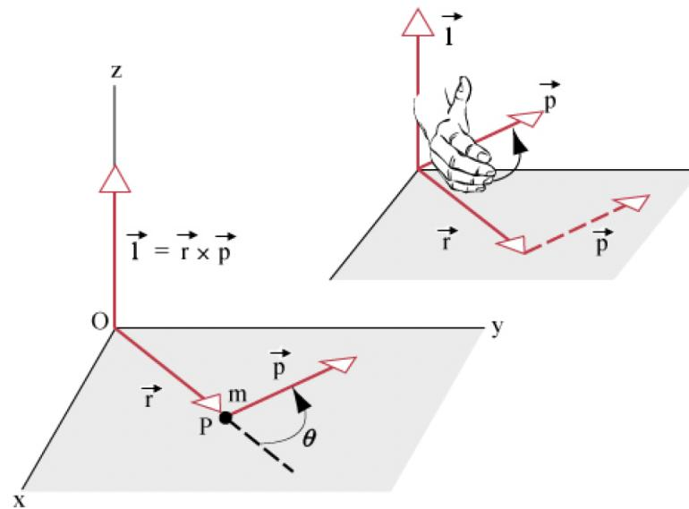
Il **momento angolare** o **momento della quantità di moto** è **sempre definito rispetto ad un punto** che chiamiamo *polo*. Nella figura di sopra il polo è indicato con  $O$  ed è l'origine del sistema di coordinate. Fissato un sistema di coordinate il polo può essere un generico punto dello spazio. Il momento angolare è definito rispetto a questo punto come
