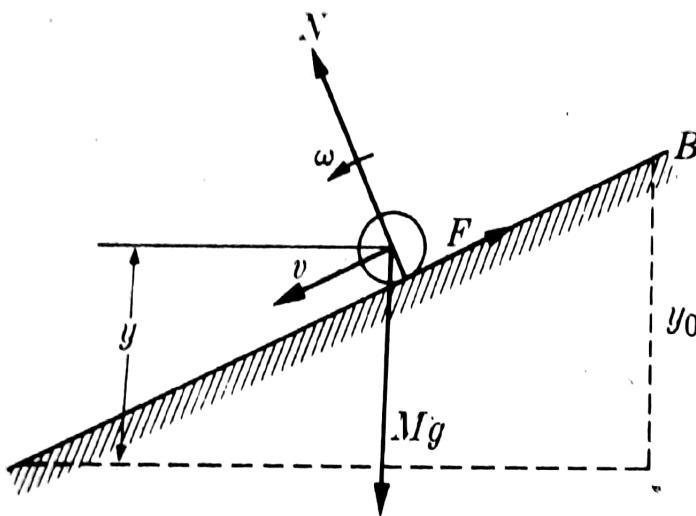
Un corpo rotondo (cilindro, sfera, anello) rotola su un piano inclinato partendo da un punto che si trova ad un'altezza  $y_0$ . Qual è la velocità quando arriva alla base del piano?
