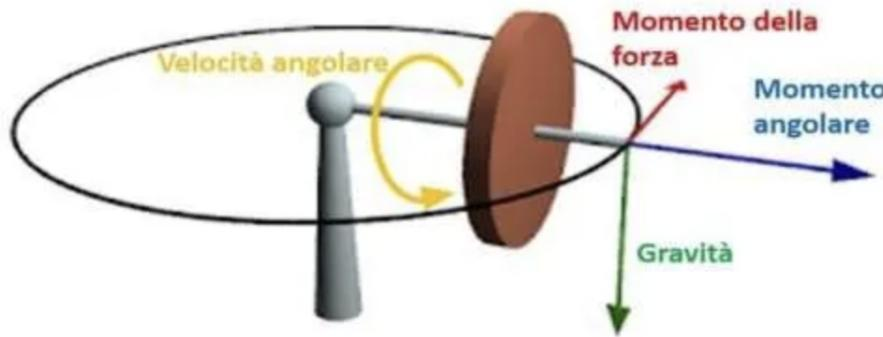
Gravità =  $\vec{F}_G = M\vec{g}$ ; Velocità angolare  $\vec{\omega}$ ; Momento angolare  $\vec{L} = I\vec{\omega}$ ; Momento torcente della forza  $\vec{\tau} = \vec{r} \times \vec{F}_G$ . Dato che le direzioni di  $\vec{r}$ ,  $\vec{\omega}$ ,  $\vec{F}_G$  sono ortogonali,  $d\vec{L}/dt = 0$ , e la relazione tra i moduli è
