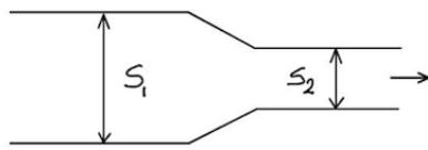
In un tubo orizzontale, la cui sezione  $S_1$  presenta una strozzatura di sezione  $S_2 < S_1$ , scorre in modo stazionario un liquido ideale di densità  $\rho$ . La differenza di pressione è  $\Delta p$ . Calcola la massa di liquido che passa attraverso una sezione del tubo nell'unità di tempo.
