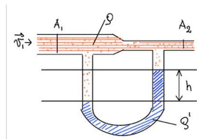
due rami collegano le due parti del condotto. Il tubo ad U contiene un liquido, di densità  $\rho'$ , il cui livello nel ramo che collega la parte del condotto con sezione  $A_2$  si trova ad un'altezza  $h$  superiore al livello del ramo che collega il condotto nella parte la cui sezione è  $A_1$ . Trovare il valore del modulo della velocità  $v_1$  dell'aria, in funzione delle sezioni  $A_1$  e  $A_2$ , delle densità  $\rho$  e  $\rho'$  e dell'accelerazione di gravità  $g$ .
