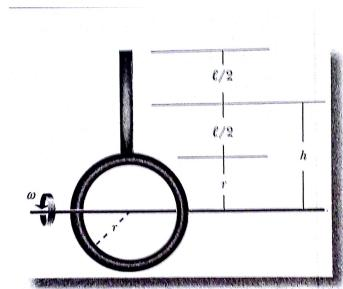
ma, partendo da fermo, ruota attorno all'asse orizzontale, da una posizione iniziale con l'asta in alto (rappresentata in figura).
