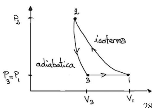
Un gas composto da  $n$  moli di molecole monoatomiche è sottoposto al ciclo mostrato nella figura. La massa molare di questo gas è  $M_m$ . Noto il valore delle pressioni  $P_1 = P_3$  e dei due volumi  $V_1$  e  $V_3$  calcolare le seguenti quantità.
