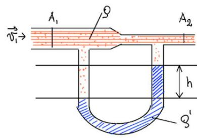
due rami collegano le due parti del condotto. Il tubo ad U contiene un liquido, di densità  $\rho'$ , il cui livello nel ramo che collega la parte del condotto con sezione  $A_2$  si trova ad un'altezza  $h$  superiore al livello del ramo che collega il condotto nella parte la cui sezione è  $A_1$ . Trovare il valore del modulo della velocità  $\vec{v}_1$  dell'aria, in funzione delle sezioni  $A_1$  e  $A_2$ , delle densità  $\rho$  e  $\rho'$  e dell'accelerazione di gravità  $g$ .
