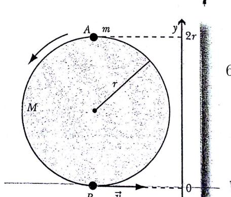
Un disco omogeneo di massa  $M$  e raggio  $r$ , può ruotare senza attriti attorno ad un
