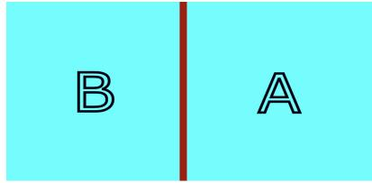
Un cilindro di materiale isolante di diametro  $D$  e lunghezza  $L$  possiede al suo interno una parete isolante, di spessore  $s$ , che si può muovere. Inizialmente nelle due parti del contenitore,  $A$  e  $B$  rispettivamente c'è la stessa quantità di gas alla temperatura  $T_i$  e alla pressione  $\mathcal{P}_i$ . Il gas si comporta come un gas ideale.
