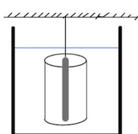
Un cilindro di volume  $V_c$  è costituito da un cilindro di legno di densità  $\rho_l$  in cui è praticato un foro cilindrico coassiale di volume  $V_{Pb}$  riempito di piombo di densità  $\rho_{Pb}$ . Il corpo è
