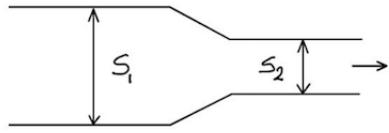
differenza di pressione è  $\Delta p$ . Calcola la massa di liquido che passa attraverso una sezione del tubo nell'unità di tempo.
