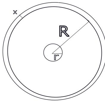
Una sfera di raggio  $r$  è mantenuta ad una temperatura  $T$ . Ipotizziamo che la sua emissività sia uguale ad 1. Questa sfera che irradia si trova al centro di un guscio sferico di raggio  $R$  e spessore  $x$ . La superficie interna di questo guscio sferico è annerita in modo che tutta la radiazione che la colpisce sia assorbita. Il guscio sferico ha conducibilità  $\lambda$ . Conoscendo il valore della costante di Stefan-Boltzmann  $\sigma$  calcolare le seguenti quantità.
