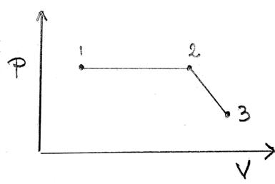
Un sistema composto da un gas ideale biatomico senza eccitazioni vibrazionali, la cui capacità termica a volume costante è  $C_v$ , è stottoposto alle trasformazioni indicate nella figura. Sono noti i seguenti dati  $T_1, P_1, T_2, V_2, T_3, P_3$  ( $T$  temperatura,  $P$  pressione,  $V$
