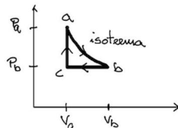
Un sistema termodinamico costituito da  $n$  moli di gas ideale e caratterizzato da un coefficiente adiabatico  $\gamma = c_p/c_v = 5/3$ , compie il ciclo reversibile mostrato in figura, in cui la trasformazione  $a \rightarrow b$  è isoterma.
