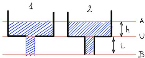
ghezza  $L$ , e con lo stesso diametro  $d$  del foro. Quando si attivano le due aperture, il livello del liquido nei due serbatoi, esposti all'aria, è  $h$  rispetto al fondo del serbatoio. Poichè le dimensioni dei serbatoi sono molto maggiori di quelle dei fori, possiamo ipotizzare che nei tempi considerati il cambiamento del livello  $h$  rimanga costante. Sapendo che la pressione esercitata sul liquido al livello A è quella atmosferica determinare:
