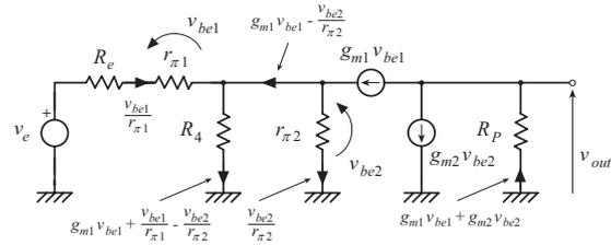
il circuito si modifica come indicato in figura. Applicando la *KVL* alla maglia costituita dalle resistenze  $R_4$  e  $r_{\pi 2}$ , si ha:
