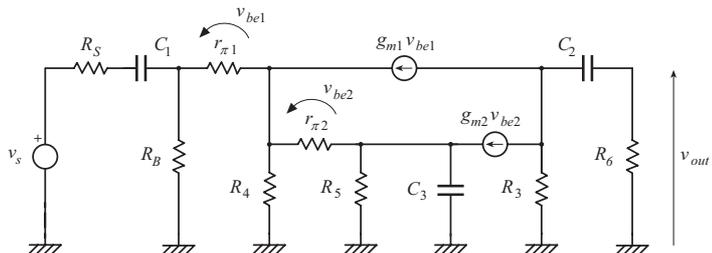
dispositivi operano in zona lineare. Il circuito equivalente dell'amplificatore per il piccolo segnale è mostrato in figura, dove:
