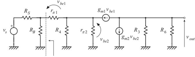
Per stabilire il guadagno  $v_{out}/v_S$  a centro banda, sostituiamo i condensatori con dei cortocircuiti, ottenendo il circuito mostrato in figura. Applicando il teorema di Thevenin a sinistra della linea tratteggiata, posto:
