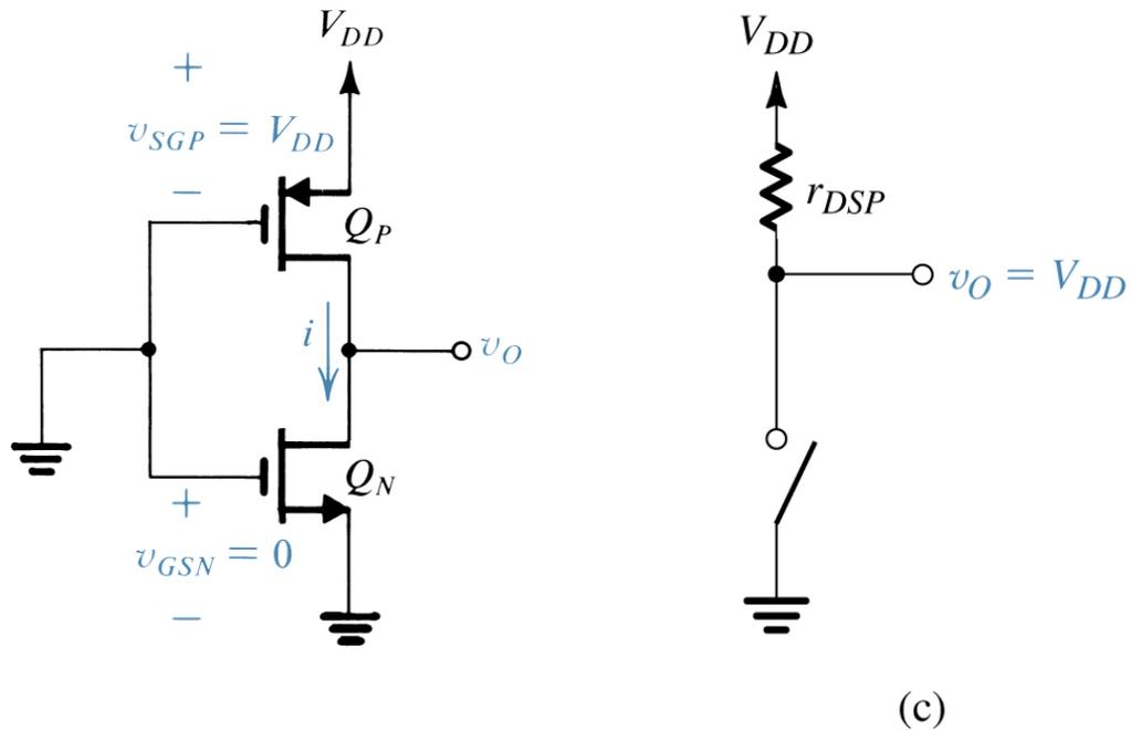
Funzionamento dell'invertitore CMOS per  $v_i$  a livello logico basso: circuito per  $v_i = 0$  V (livello logico 0, o  $V_{OL}$ ) (a sinistra) e relativo schema equivalente (a destra).
