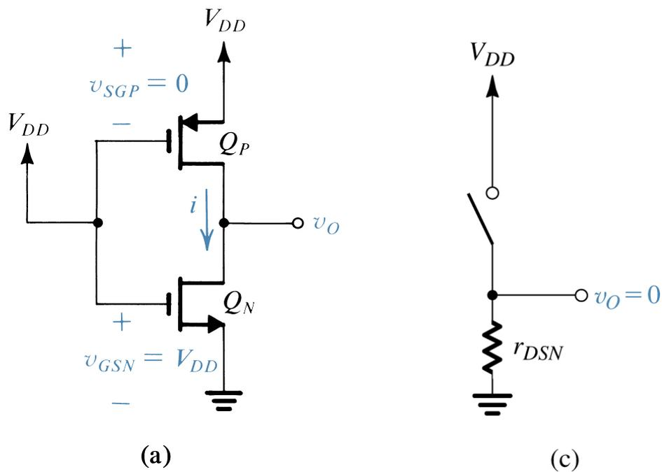
Funzionamento dell'invertitore CMOS per  $v_i$  a livello logico alto: circuito per  $v_i = V_{DD}$  (livello logico 1, o  $V_{OH}$ ) (a sinistra) e relativo schema equivalente (a destra).
