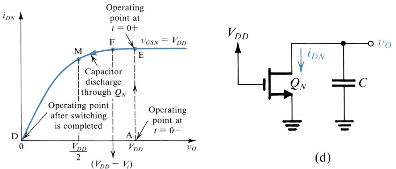
Traiettoria del punto di funzionamento in corrispondenza della transizione in ingresso dallo stato 0 allo stato 1 e relativa scarica del condensatore di carico attraverso  $Q_N$  (a sinistra); circuito di scarica del condensatore di carico (a destra).
