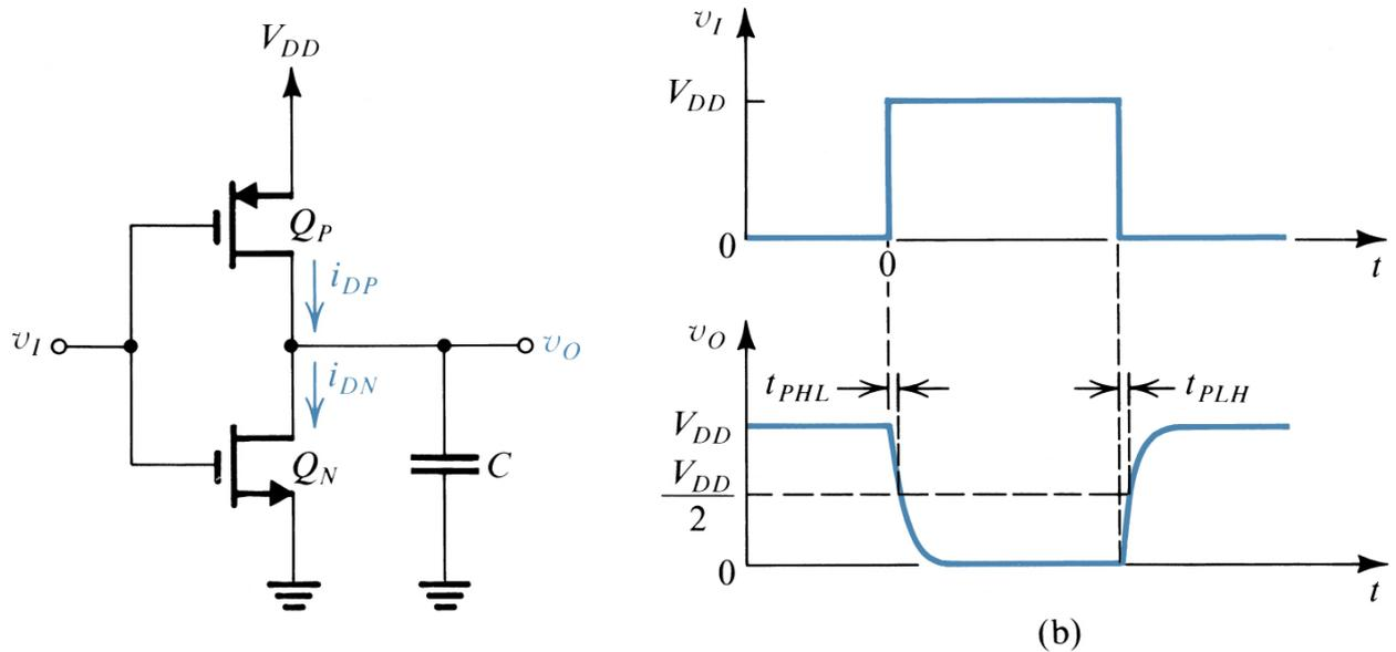
Funzionamento dinamico di un invertitore CMOS con carico capacitivo: circuito (a sinistra) e forme d'onda di ingresso e di uscita (a destra).
