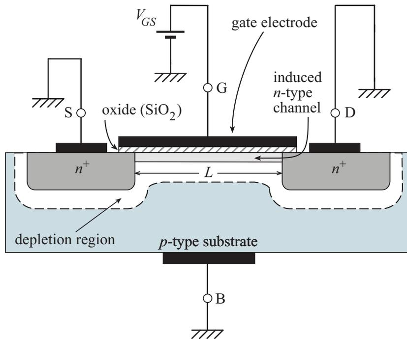
Transistor NMOS ad arricchimento con una tensione positiva applicata al gate. Un canale di tipo  $n$  è indotto sulla superficie della regione del substrato in corrispondenza del gate.
