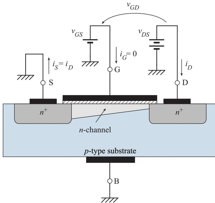
Struttura del canale di un transistor NMOS ad arricchimento per valori elevati della tensione  $V_{DS}$ . La sezione del canale diventa non uniforme e la sua resistenza aumenta al crescere di  $V_{DS}$ . In questo caso la tensione  $V_{GS}$  è mantenuta costante ad un valore  $V_{GS} > V_{TH}$ .
