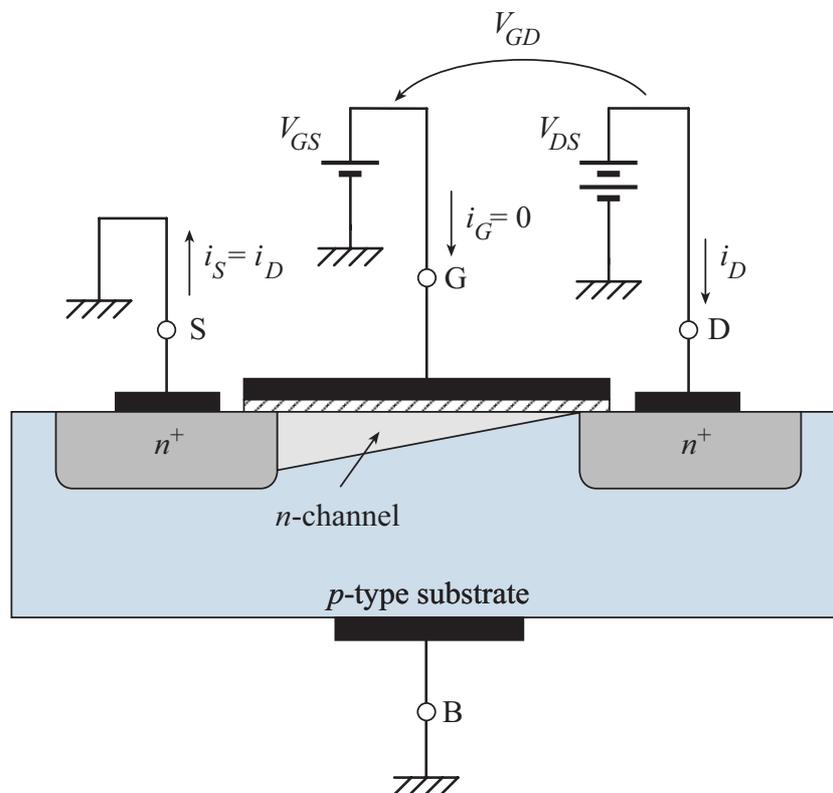
Struttura del canale di un transistor NMOS ad arricchimento per  $V_{GD} = V_{TH}$ , ovvero per  $V_{DS} = V_{GS} - V_{TH}$ : la larghezza del canale si annulla in prossimità del *drain*. Tale condizione è detta di "strozzamento" del canale, o di *pinch-off*.
