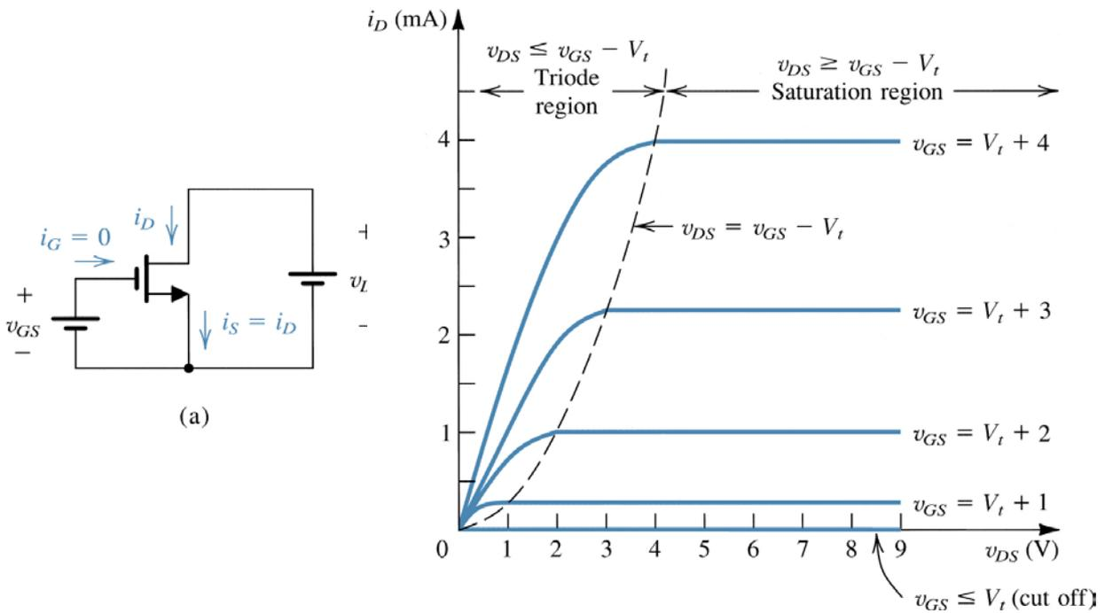
(a) Transistor MOSFET ad arricchimento di tipo  $n$  polarizzato. (b) Caratteristiche di uscita  $I_D$ - $V_{DS}$  per un dispositivo con  $V_{TH} = 1\text{ V}$  e  $k_n (W/L) = 0.5\text{ mA/V}^2$ .
