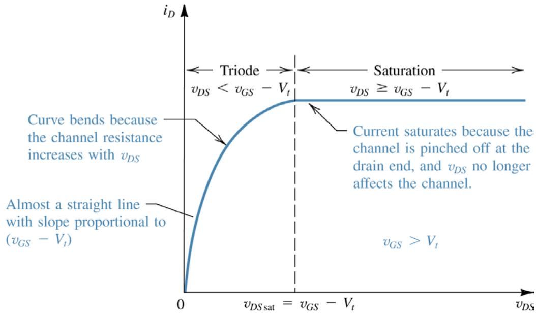
Corrente di *drain*  $I_D$  in funzione della tensione  $V_{DS}$  per un transistor NMOS ad arricchimento funzionante con  $V_{GS} > V_{TH}$ .
