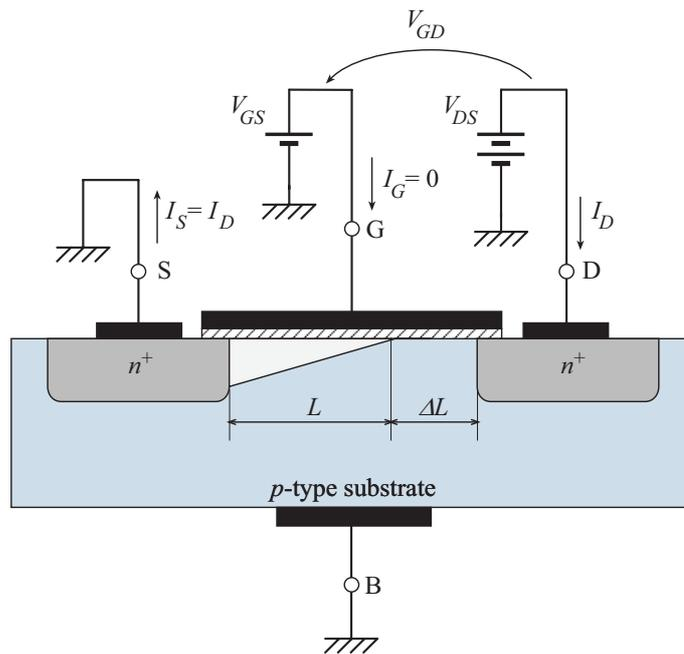
All'aumentare di  $V_{DS}$  oltre il valore di saturazione  $V_{DS\text{ SAT}}$  la posizione del *pinch-off* nel canale si allontana dal *drain*, determinando così la diminuzione della lunghezza effettiva del canale di una quantità  $\Delta L$ .
