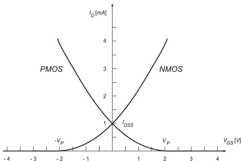
Caratteristiche  $I_D - V_{GS}$  per transistor MOSFET a svuotamento di tipo  $n$  e di tipo  $p$  in saturazione ( $I_{DSS} = 1 \text{ mA}$ ,  $V_P = 2 \text{ V}$ ).
