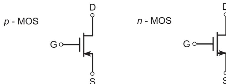
Simboli per i MOSFET a svuotamento a canale  $n$  (a destra) e a canale  $p$  (a sinistra). La freccia identifica il morsetto di *source* e il verso positivo della corrente  $I_D$ .
