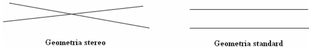
**Figura 1.5:** *Disposizione geometrica longitudinale dei fili in una Camera a Deriva cilindrica di tipo stereo e standard.*
