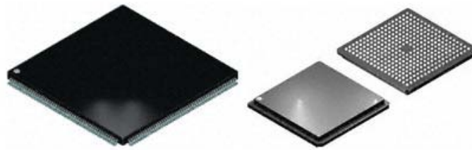
Figura 1.29:SPARTAN 3E con package QFP (destra) e BGA (sinistra)
