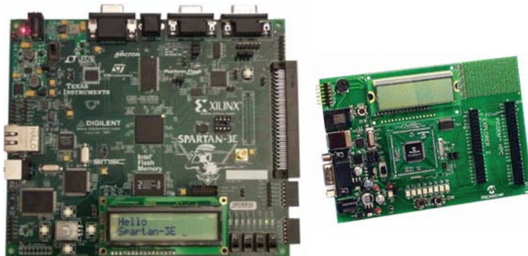
Figura 1.31: Sistema di sviluppo: A sinistra Spartan-3E FPGA Starter Kit Board a destra Microchip PICDEM PIC18 Explorer
