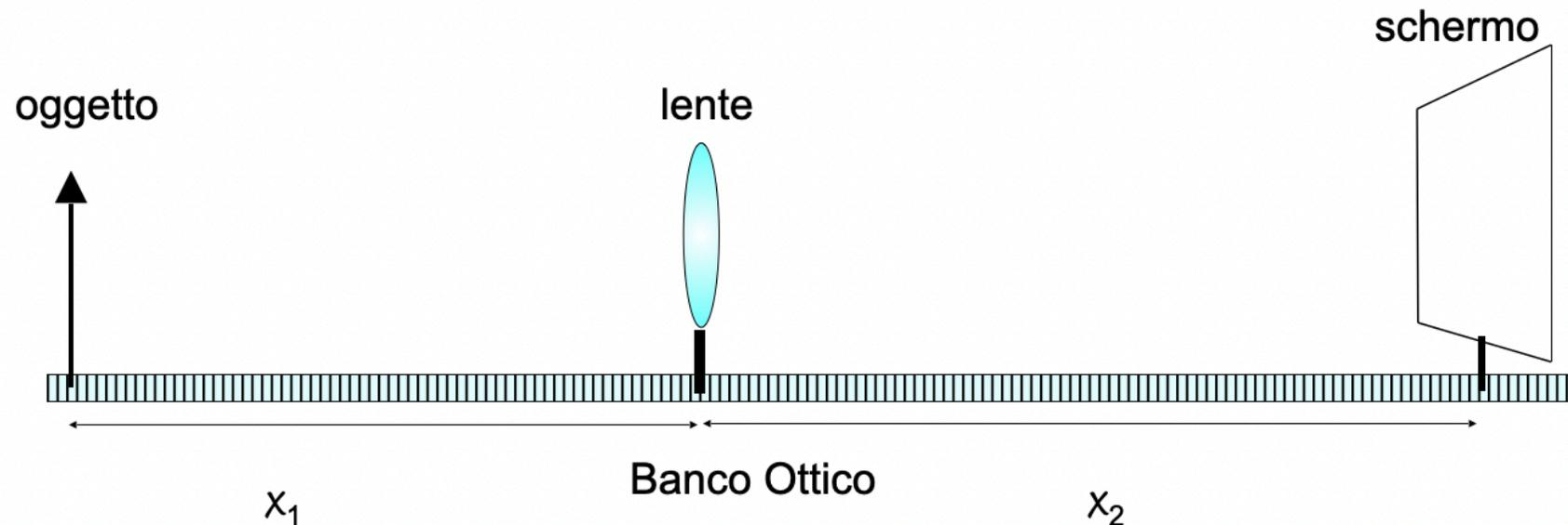
Per determinare la lunghezza focale della lente occorre misurare simultaneamente la distanza dalla lente dell'oggetto ( $x_1$ ) e la distanza dalla lente dell'immagine ( $x_2$ ).
