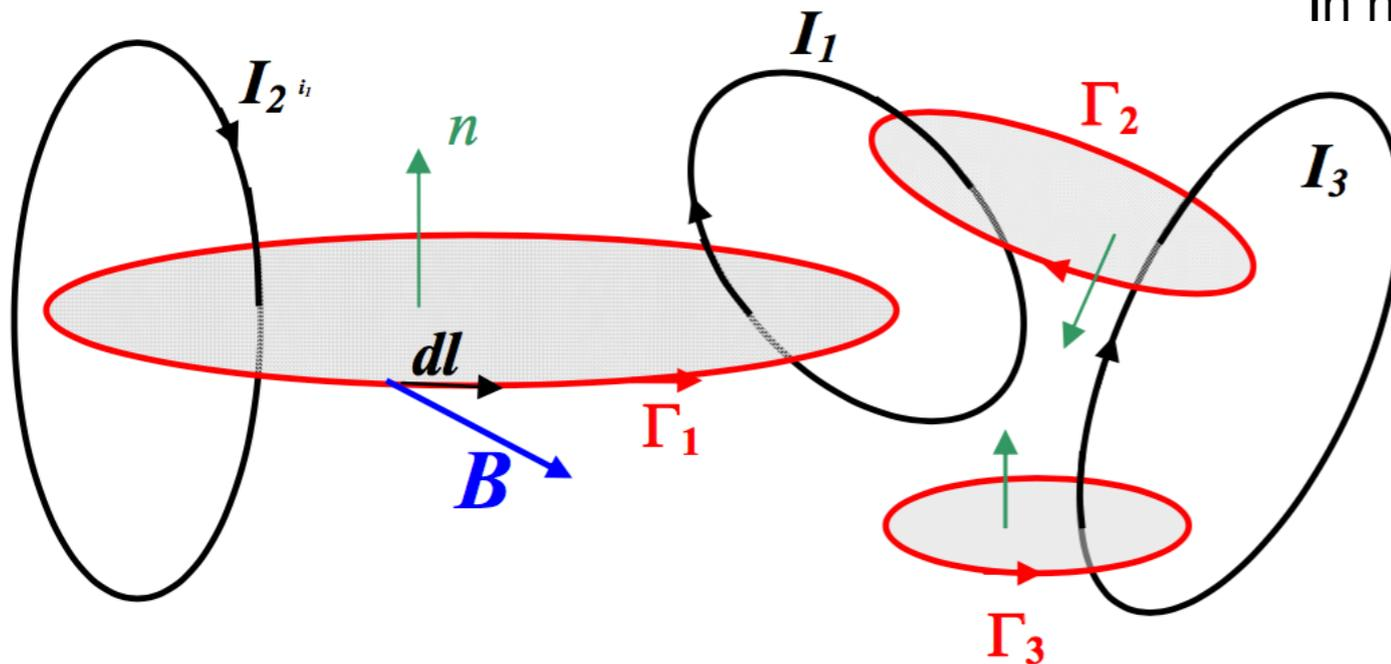
definizione di **corrente concatenata** con un circuito geometrico  $\Gamma$
