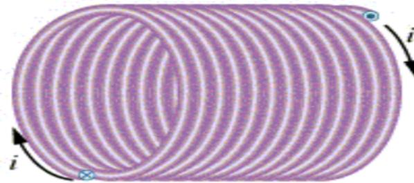
**Solenoid:** è costituito da un filo avvolto a spirale attorno ad un cilindro cavo di sezione  $S$ . Per un solenoide ideale (tale che la sua lunghezza  $L$  sia molto maggiore del diametro del solenoide) si genera in ogni punto all'interno del volume cilindrico un campo magnetico d'intensità uniforme pari a  $B = \mu_0 n I$ , dove
