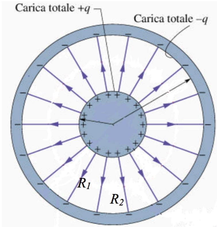
sfera conduttrice cava di raggio interno  $R_2$  e sfera interna conduttrice di raggio  $R_1$
