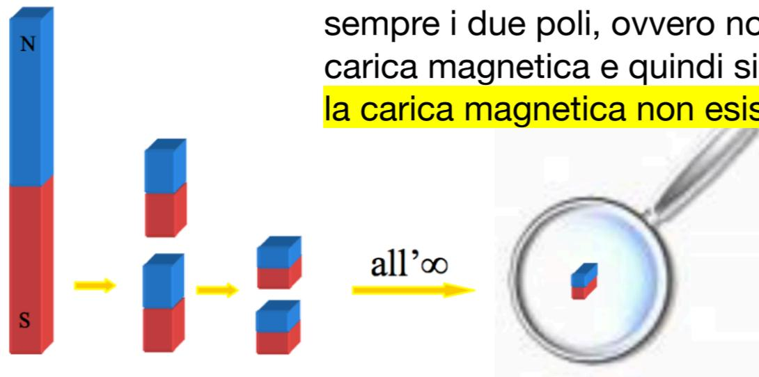
**Le linee di campo si originano e terminano sulle cariche; non esistendo le cariche magnetiche le linee del campo  $B$  devono essere delle linee chiuse**
