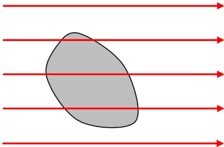
$$\vec{E}_{TOT} = \vec{E}_{IND} + \vec{E}_{est} \text{ dovunque, con } \vec{E}_{TOT} = 0 \text{ all'interno}$$
