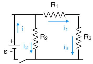
a interruttore aperto non c'è corrente in nessun ramo; tra 0 e 10s  $i=\epsilon/(R_2(R_3+R_1))/(R_1+R_2+R_3) = 10 \times 65 / (60 \times 5) = 2.17mA$ ,  $i_2 = 2mA$ ;  $i_1+i_3=0.17mA$ ,  $i_1=10V/60\Omega = 0.6mA$ ;  $E_{R_2}=(2mA)^2 R_2 T = 0.2J$ ; verso opposto rispetto a  $i_3$  (corrente positiva)
