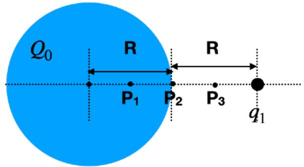
Il sistema complessivo consiste di due sistemi a simmetria sferica: la carica puntiforme  $q_1$  e la sfera uniformemente carica con carica  $Q_0$ . Il campo elettrico e il potenziale elettrostatico in tutti i punti dello spazio possono essere calcolati come somma dei campi  $E$  prodotti dai due sistemi considerati singolarmente  $\vec{E} = \vec{E}_1 + \vec{E}_0$ .
