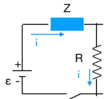
Appena il circuito e' chiuso il condensatore e' scarico ( $Q_A = 0$  e  $V_A - V_B = 0$ ) quindi dall'eq.
