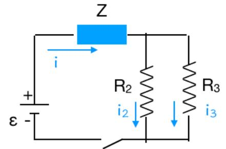
**Ricordiamo che condensatori e induttanze determinano un comportamento transiente delle correnti in un circuito. A regime (ossia quando l'interruttore del circuito e' chiuso da molto tempo la corrente in un ramo in cui sia presente un condensatore e' nulla, mentre la corrente in un ramo in cui sia presente un induttore e' pari a quella che si avrebbe se l'induttore fosse sostituito da un corto circuito).**
